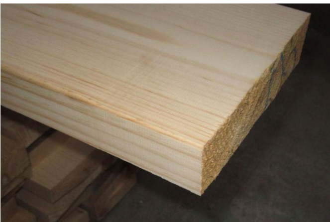
Trematerial er kom, fuktighet er 12%, god kvalitet.
